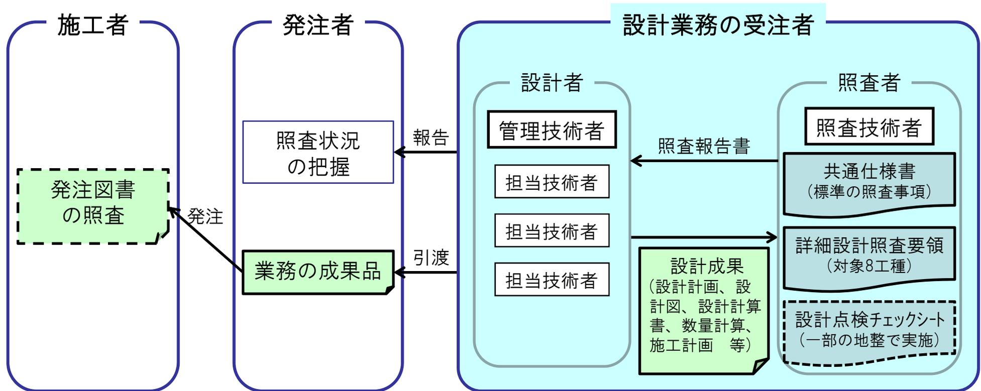
**設計成果の照査**：設計受注者が設計業務の完了までに行う、発注条件、設計の考え方、構造細目等のチェック及び技術計算等の検算
